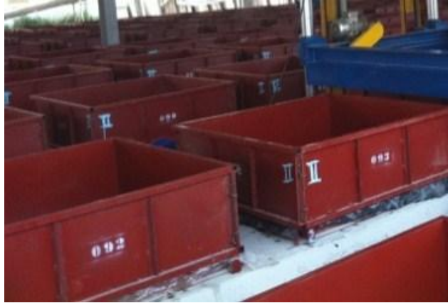
Ray üzerinde ilerleyecek Kalıplar ve Taşıyıcı Arabalar
